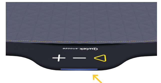
FIGUUR 2.2 - Het blauwe statuslampje; klaar voor gebruik.
