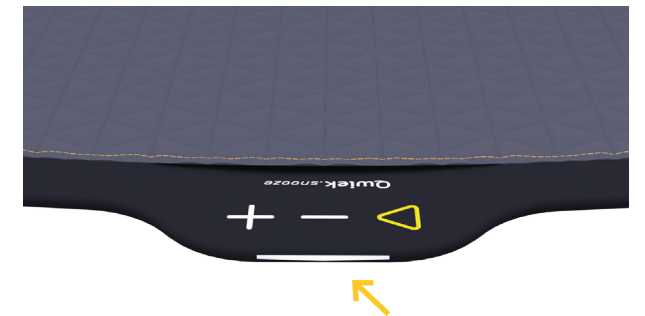
FIGUUR 2.1 - Het witte statuslampje; opstartfase.
